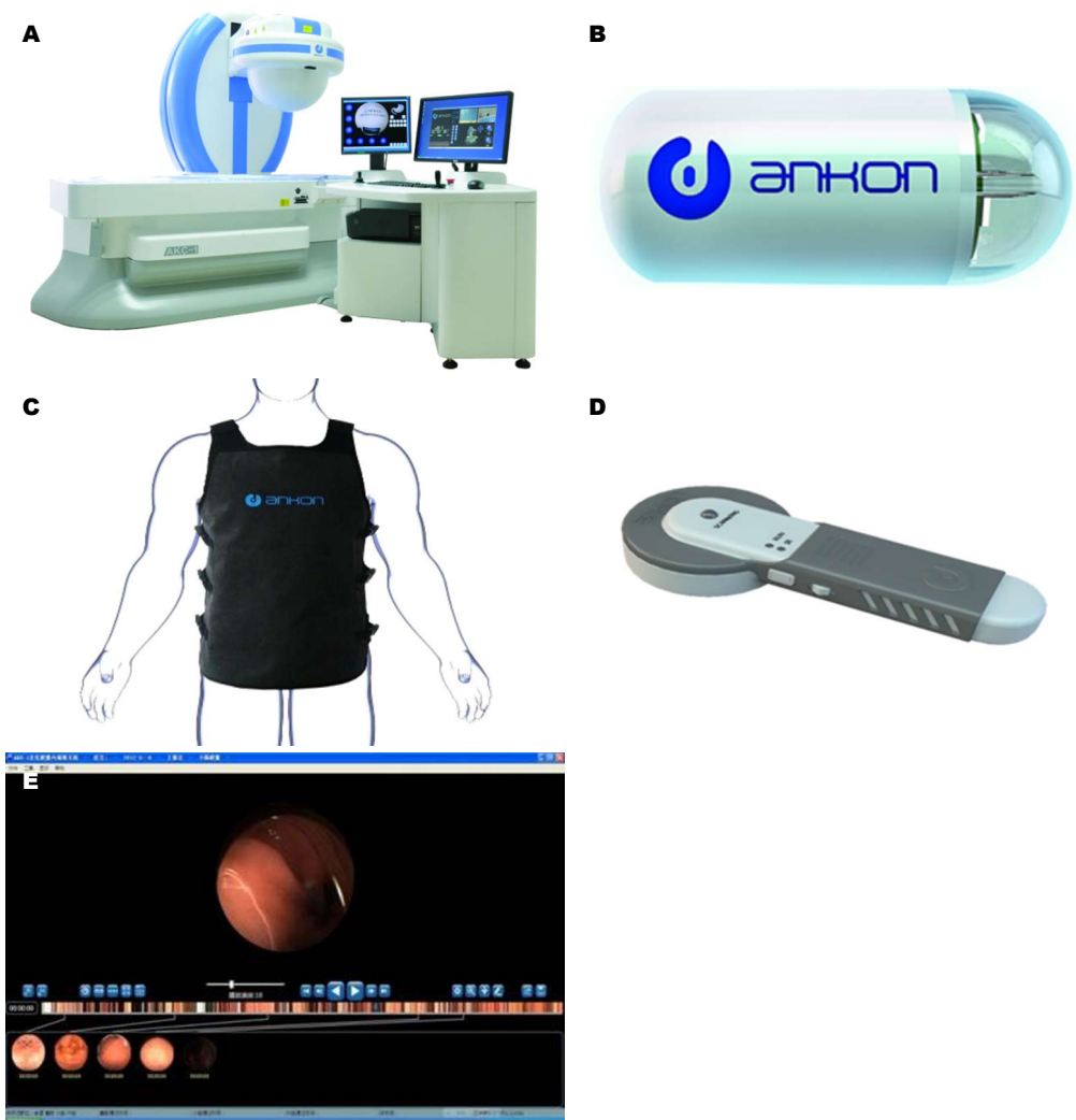
图 1 磁控胶囊内镜系统. A: 遥控胶囊内镜控制系统; B: NaviCam遥控胶囊内镜机器人; C: 便携记录器和检查服; D: 胶囊定位器; E: 控制和显示软件ESNav.
